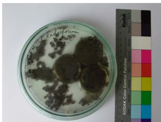
Fig. 2: Desenvolvimento de fungos sobre pedra de Ançã, através da inoculação em laboratório.
