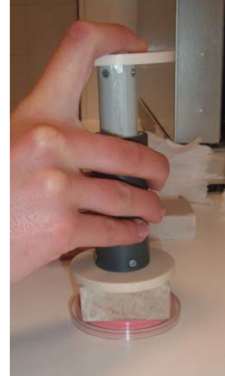
Fig. 5: Teste do método da esponja de contacto para determinação da quantidade de água que pode ser absorvida pela
